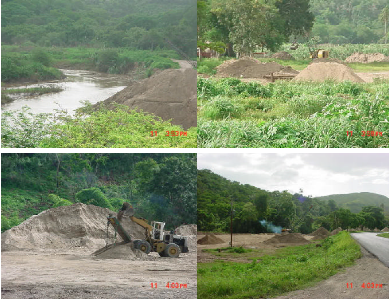
Foto 1.- Diversos saques de arena a lo largo del Río Manzanares, entre la zona conocida como Puerto de La Madera y el sector Los Apures. Estos saques incontrolados de arena incrementan notablemente la turbidez del río en la Cuenca Baja
