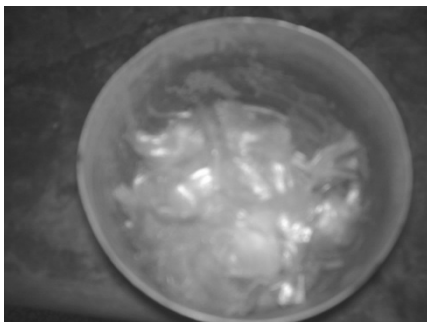
شکل ۳- الیاف پلی پروپیلن مصرفی
